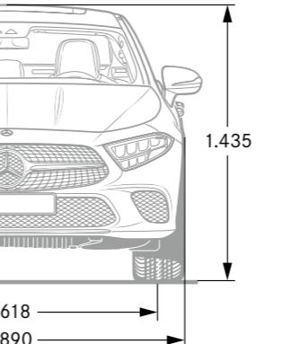
Alle Angaben in Millimetern. Die abgebildeten Maße sind Mittelwerte. Sie gelten für Fahrzeuge in Grundausstattung und in unbelastetem Zustand.
