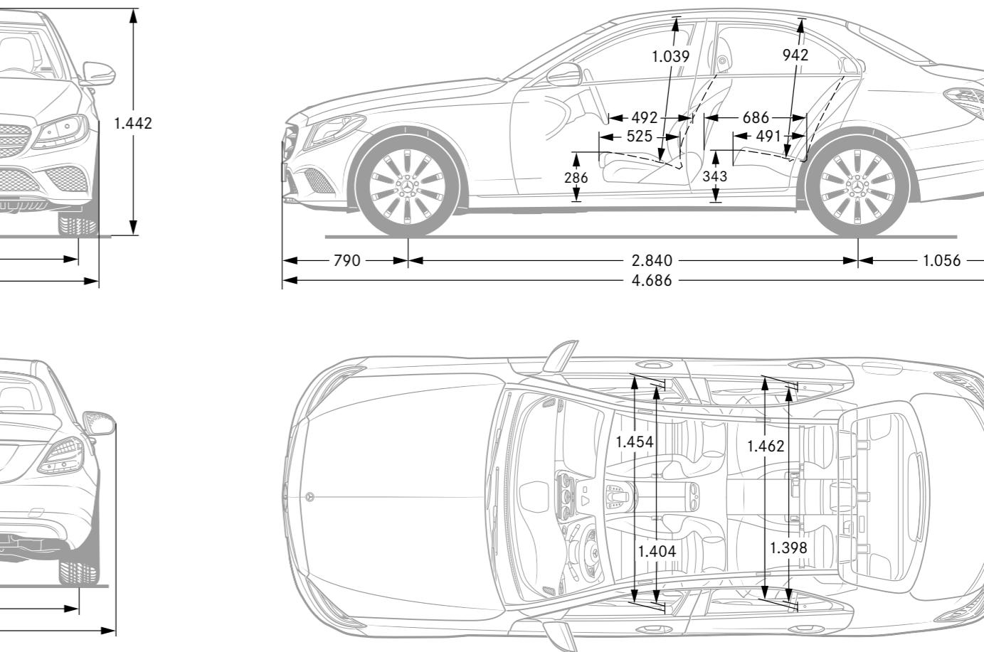
Alle Angaben in Millimetern. Die abgebildeten Maße sind Mittelwerte. Sie gelten für Fahrzeuge in Grundausstattung und in unbelastetem Zustand.
