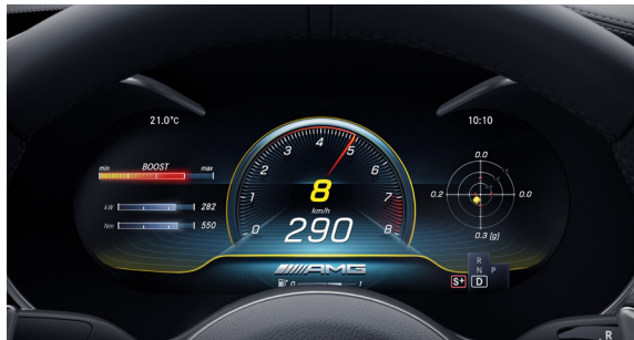
มาตรวัดความเร็วและวัดรอบเครื่องยนต์แบบ All-Digital Instrument Display ขนาด 12.3 นิ้ว
