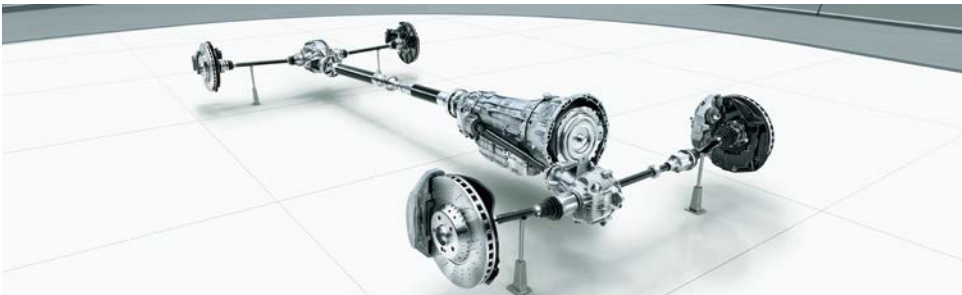
次世代の俊敏性、快適性、環境性能を実現する 全天候型フルタイム四輪駆動システム4MATIC
