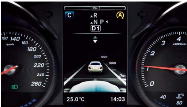
ディスタンスパイロット・ディストロニック&ステアリングパイロットのディスプレイ表示
