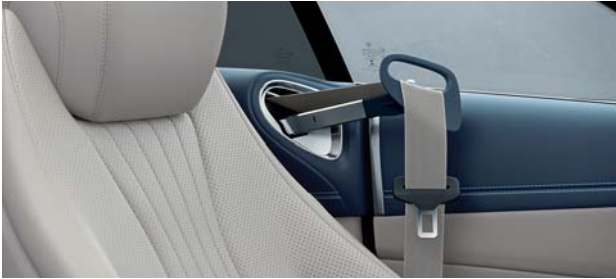
シートベルト装着をサポートする オートマティックベルトフィーダー
