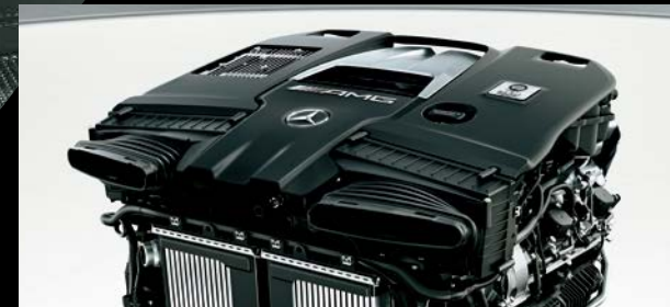
痺れるほどのハイパフォーマンスと高効率を実現する 4.0L V型8気筒直噴ツインターボエンジン
