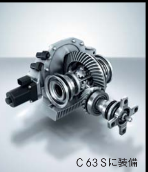
C 63 Sに装備 電子制御AMGリミテッド・スリップ・デフ
