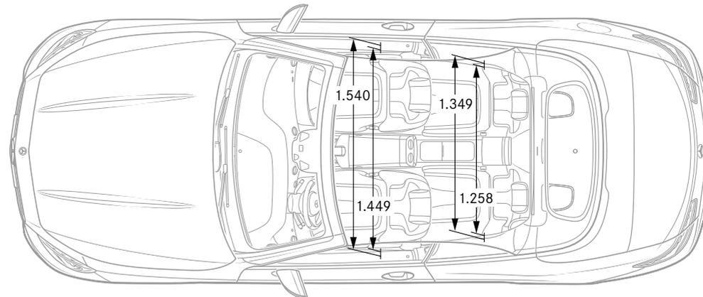
Alle Angaben in Millimetern. Die abgebildeten Masse sind Mittelwerte. Sie gelten für Fahrzeuge in Grundausstattung und in unbelastetem Zustand.
