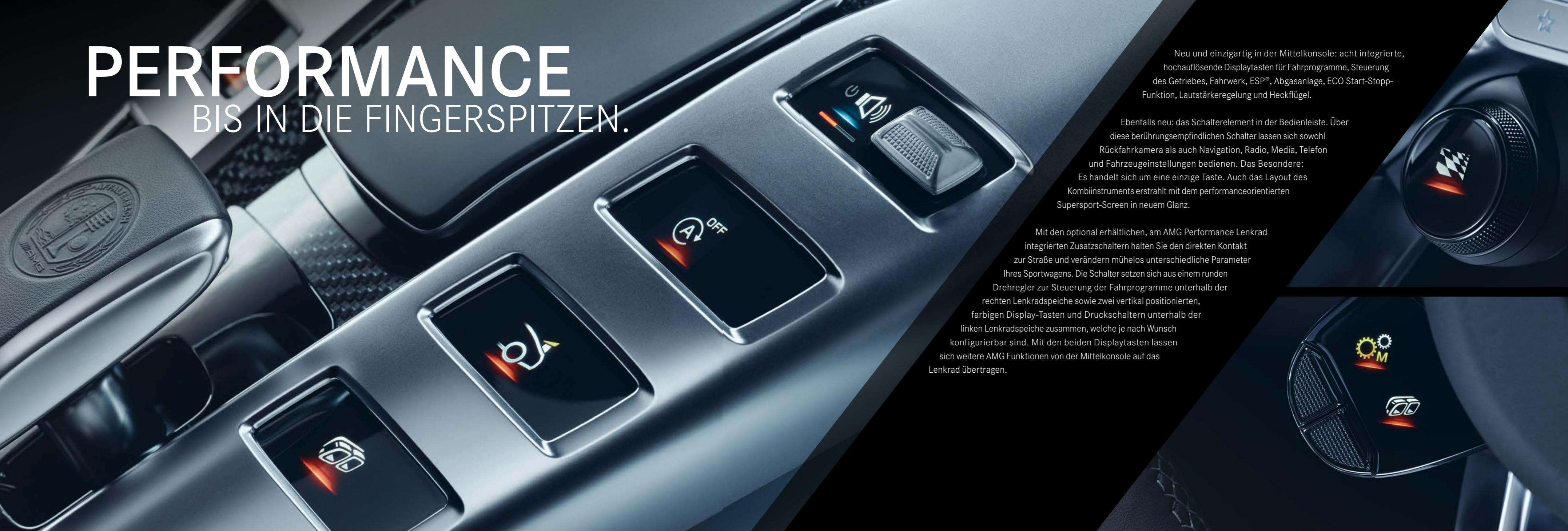
Neu und einzigartig in der Mittelkonsole: acht integrierte, hochauflösende Displaytasten für Fahrprogramme, Steuerung des Getriebes, Fahrwerk, ESP®, Abgasanlage, ECO Start-Stop-Funktion, Lautstärkeregelung und Heckflügel.
