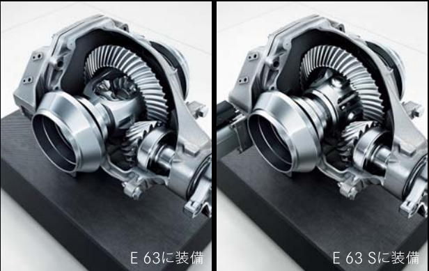
機械式AMGリミテッド・スリップ・デフ 電子制御AMGリミテッド・スリップ・デフ
