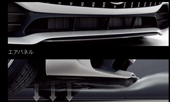
アクティブ・エアロダイナミクス・システム
