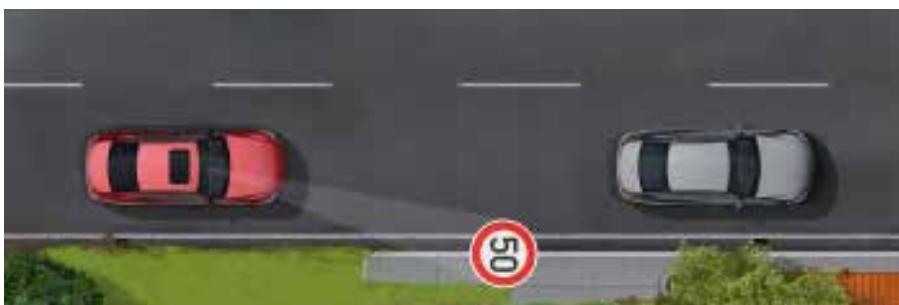
Der **Aktive Geschwindigkeitslimit-Assistent** übernimmt per Kamera erfasste oder dem Navigationssystem bekannte Geschwindigkeitslimits als neue Setzgeschwindigkeit des **Aktiven Abstands-Assistenten DISTRONIC**.
