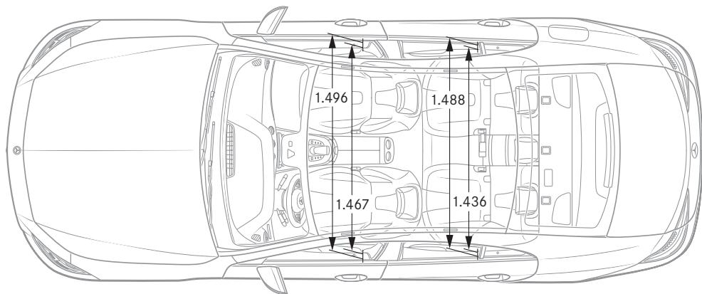
Alle Angaben in Millimetern. Die abgebildeten Maße sind Mittelwerte. Sie gelten für Fahrzeuge in Grundausstattung und in unbelastetem Zustand.
