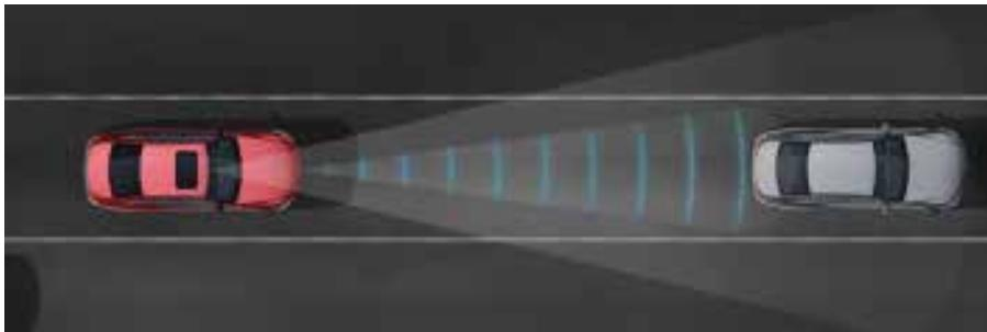
Der **Aktive Abstands-Assistent DISTRONIC** und der **Aktive Lenk-Assistent** können im Stadtverkehr, auf Landstraßen und Autobahnen automatisch den korrekten Abstand zu vorausfahrenden Fahrzeugen halten und diesen im Geschwindigkeitsbereich bis 210 km/h folgen.
