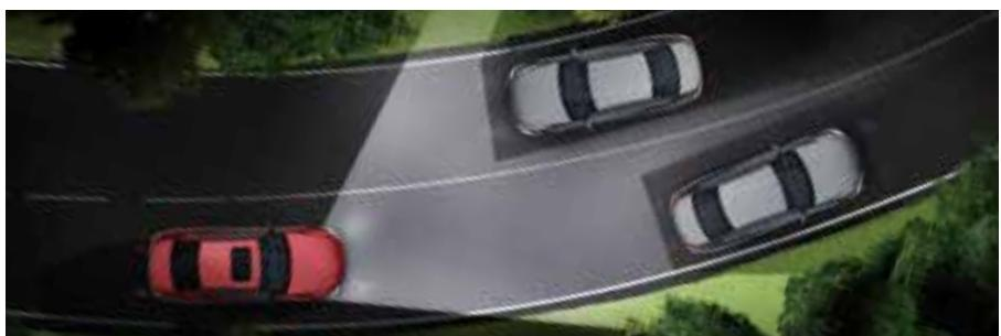
Die **MULTIBEAM LED Scheinwerfer** reagieren mit einzeln steuerbaren LEDs schnell auf die aktuelle Verkehrssituation. Das Teilfernlicht spart erkannte Verkehrsteilnehmer aus – bei freier gerader Strecke schaltet das **ULTRA RANGE Fernlicht** auf eine dauerhaft weite Ausleuchtung der Fahrbahn.
