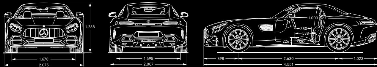
Alle Angaben in Millimetern. Die abgebildeten Maße sind Mittelwerte. Sie gelten für Fahrzeuge in Grundausstattung und in unbelastetem Zustand.
