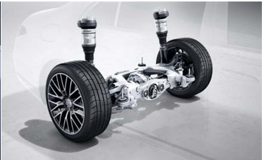
201 – Hinterachslenkung mit Einstellung des Lenkeinschlags auf 4,5°
