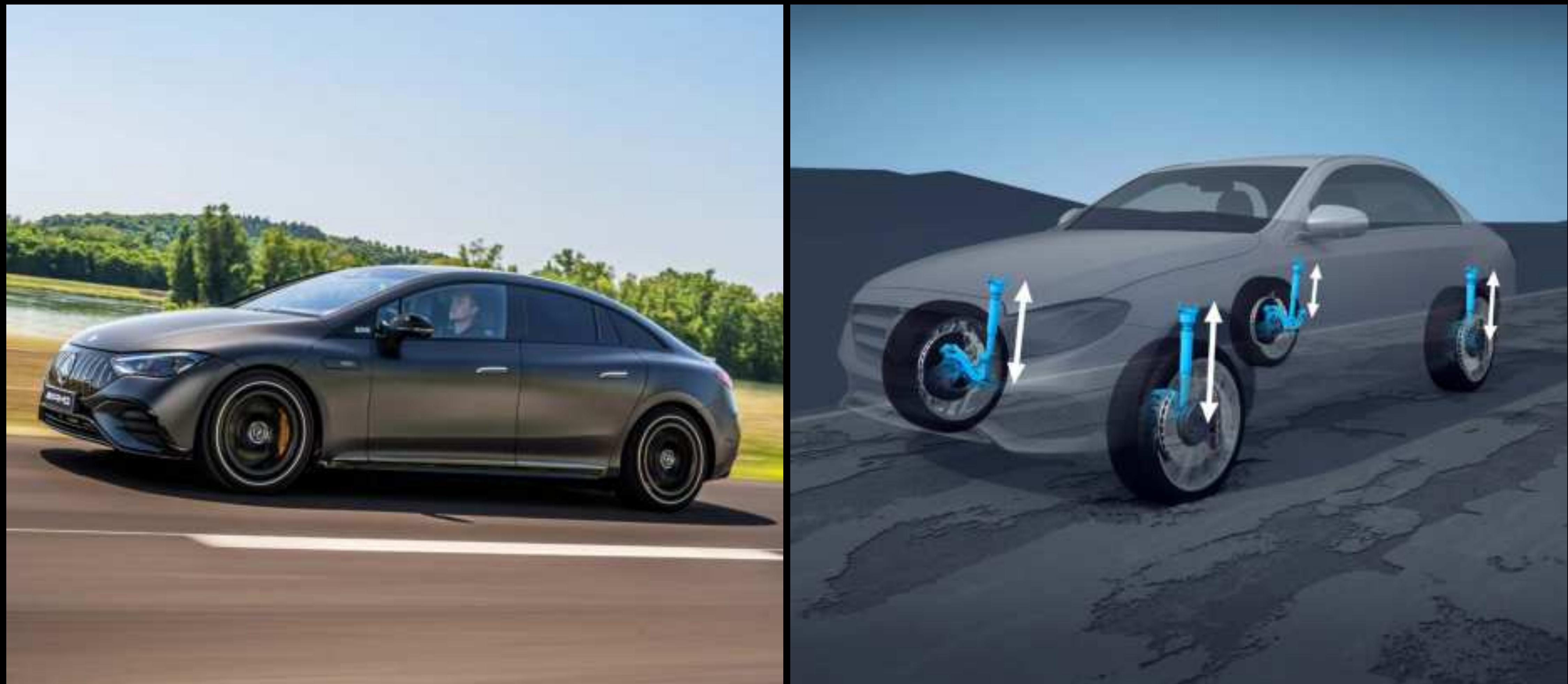
에어매틱 에어 서스펜션은 거친 노면에서도 탁월한 승차감을 제공합니다. 각각의 휠을 개별 조정할 수 있으며, 올라운드 레벨 제어 시스템의 정교한 센서를 통해 서스펜션을 조절할 수 있습니다. 특히 고속 주행 시 에어 서스펜션을 낮춰 핸들링을 향상시키고, 바람의 저항력을 줄여 역동적인 드라이빙이 가능하도록 지원합니다. 또한, 필요에 따라 서스펜션을 올려 경사로 또는 험로 주행 전 지상고를 높일 수 있습니다. (기본사양)
