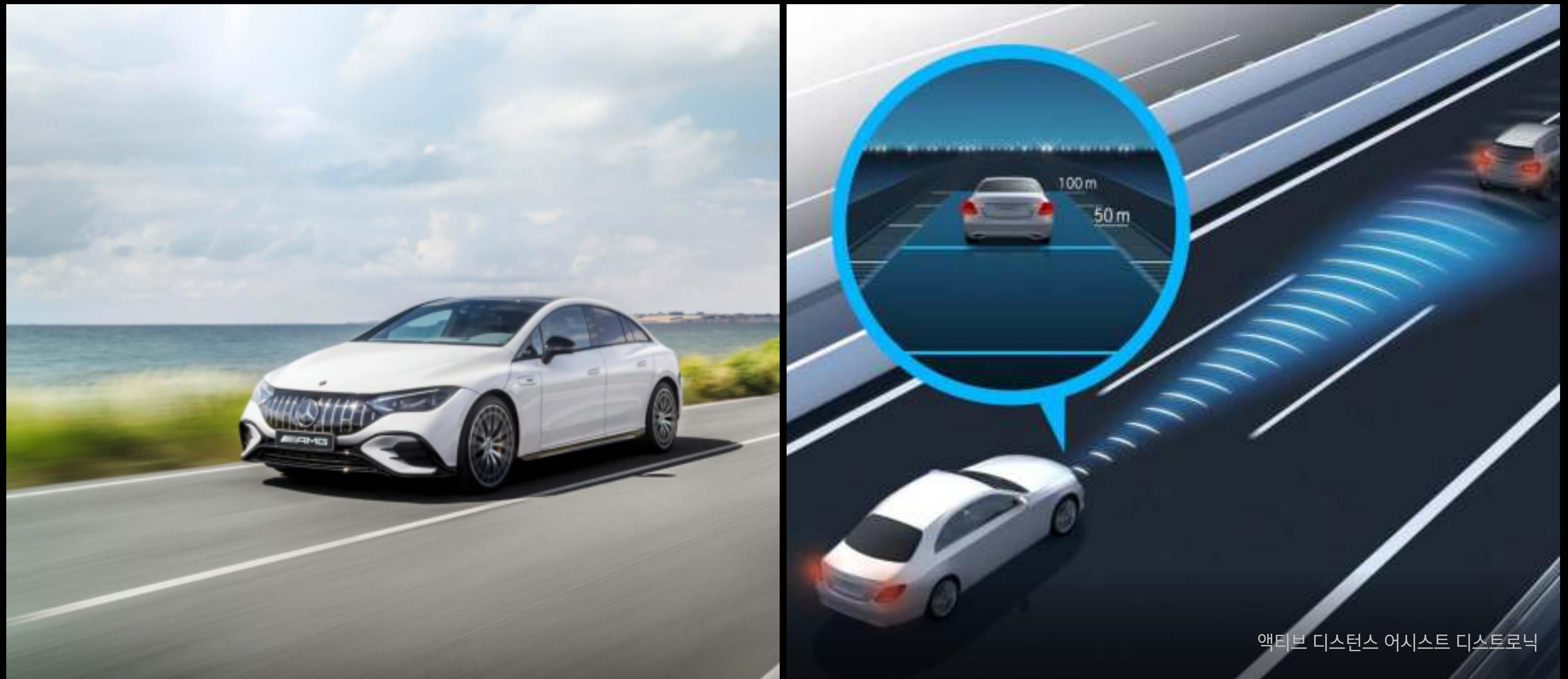
카메라, 레이더 및 초음파로 구성된 센서 시스템이 주변 환경을 분석하여 속도, 조향 제어 및 차간 거리 유지 등 필요한 시점에 적절한 주행 보조 기능으로 발휘됩니다. 코너, 원형 교차로, 나들목 또는 터널 등과 같은 환경을 고려하면서 이동하는 트래픽에 따라 운전자를 대신하여 제동 및 가속을 제어합니다. 충돌 위험이 있는 경우 먼저 시청각적 경고로 운전자에게 알림을 주고, 필요 시 자동으로 제동 기능을 실행합니다. 고속도로 혹은 차선 표시가 있는 일반 도로에서 의도치 않게 차선을 벗어나는 경우 시스템은 차량의 방향을 수정하기 위해 조향에 개입하여 탑승자와 보행자를 보호하며, 사고의 위험을 줄일 수 있도록 도움을 줍니다. (기본사양)
