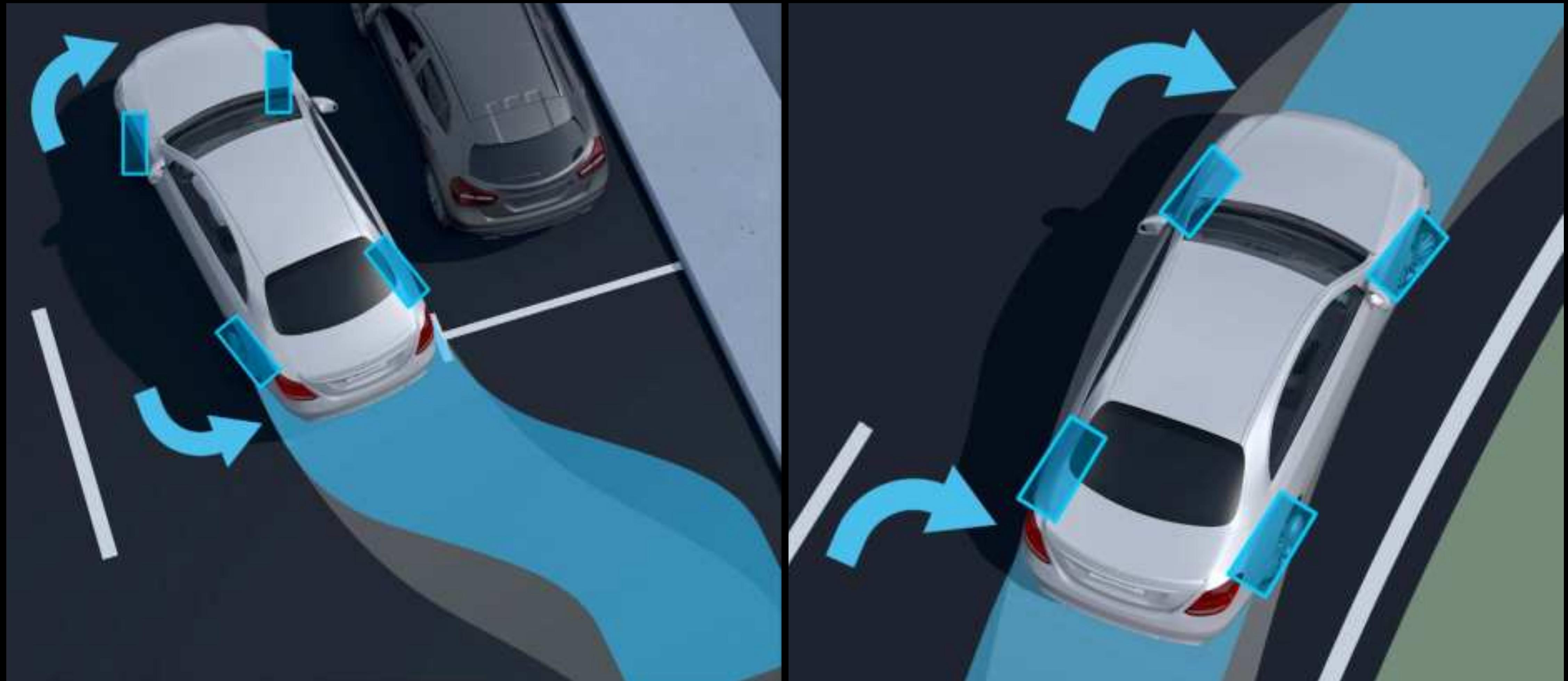
최대 조향각이 3.6°인 리어 액슬 스티어링은 회전 반경을 감소시켜 민첩한 핸들링이 가능하게 합니다. 또한, 프론트 액슬과 리어 액슬이 상호 작용하여 시내 또는 시골길 주행 시 최소한의 조향으로도 구동이 가능하도록 설계되었습니다. 60km/h 미만의 속도에서는 뒷바퀴가 앞바퀴와 반대 방향으로 조향되며, 이를 통해 차량의 기동성이 향상됩니다. 특히 회전하거나 빠른 방향 전환 또는 천천히 움직일 때 효과적으로 반응합니다. 또한, 60km/h를 초과할 경우 뒷바퀴는 앞바퀴와 동일한 방향으로 조향합니다. 이에 따라 고속 주행 시 안정성 있는 핸들링과 전반적인 안전성을 향상시켜 주어, 빠른 차선 변경 또는 회피 기동 시에도 안전하게 주행할 수 있습니다. (기본사양)
