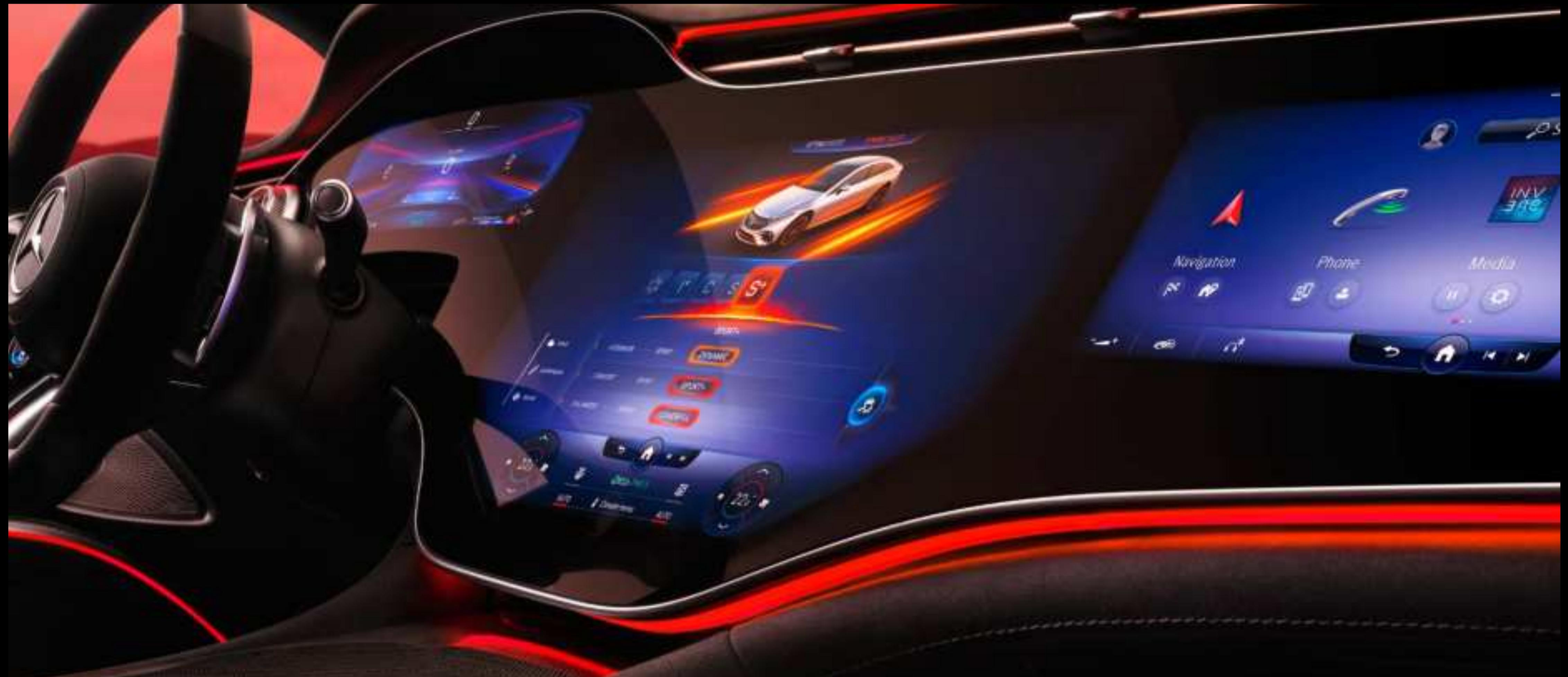
곡선형 패널 아래 3개의 디스플레이가 결합되어 하나의 MBUX 하이퍼스크린을 구성합니다. 중앙 및 동반석 디스플레이에는 보다 선명한 이미지 구현을 위해 OLED 기술을 기반으로 설계되었습니다. 개별 픽셀들은 자체적으로 발광하며, 제어되지 않는 픽셀은 꺼진 상태로 유지되어 짙은 검은색으로 보여집니다. 활성화된 OLED 픽셀은 LCD 디스플레이보다 더 화려하게 빛을 내어 시야각과 조명 조건에 관계 없이 선명한 대비값을 구현합니다.
