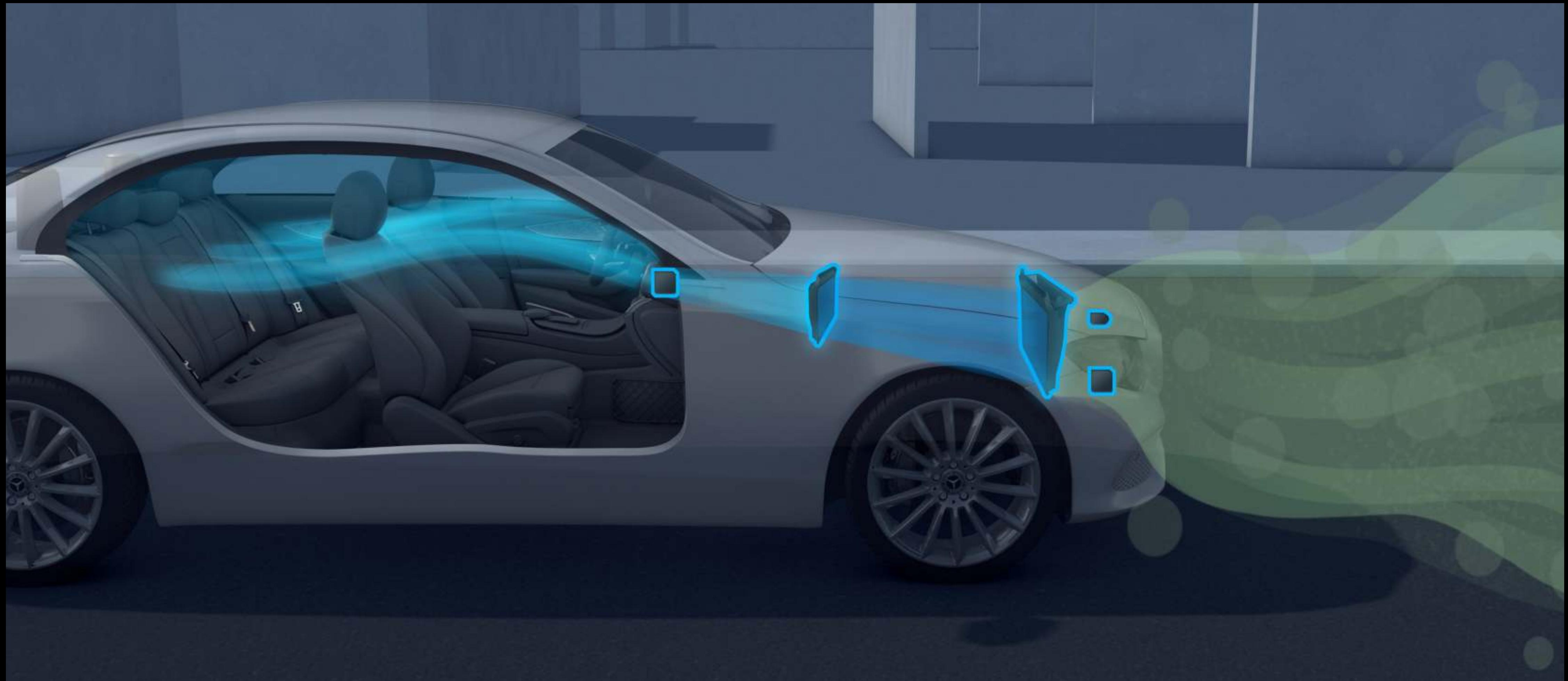
공기 청정 패키지는 차량 내부와 외부의 공기질을 모니터링하고 그 결과를 MBUX 멀티미디어 시스템으로 보여줍니다. 측정된 값이 특정 범위에 속하게 되면 쾌적한 실내 환경을 위해 순환 모드를 자동으로 전환합니다. (기본사양)
