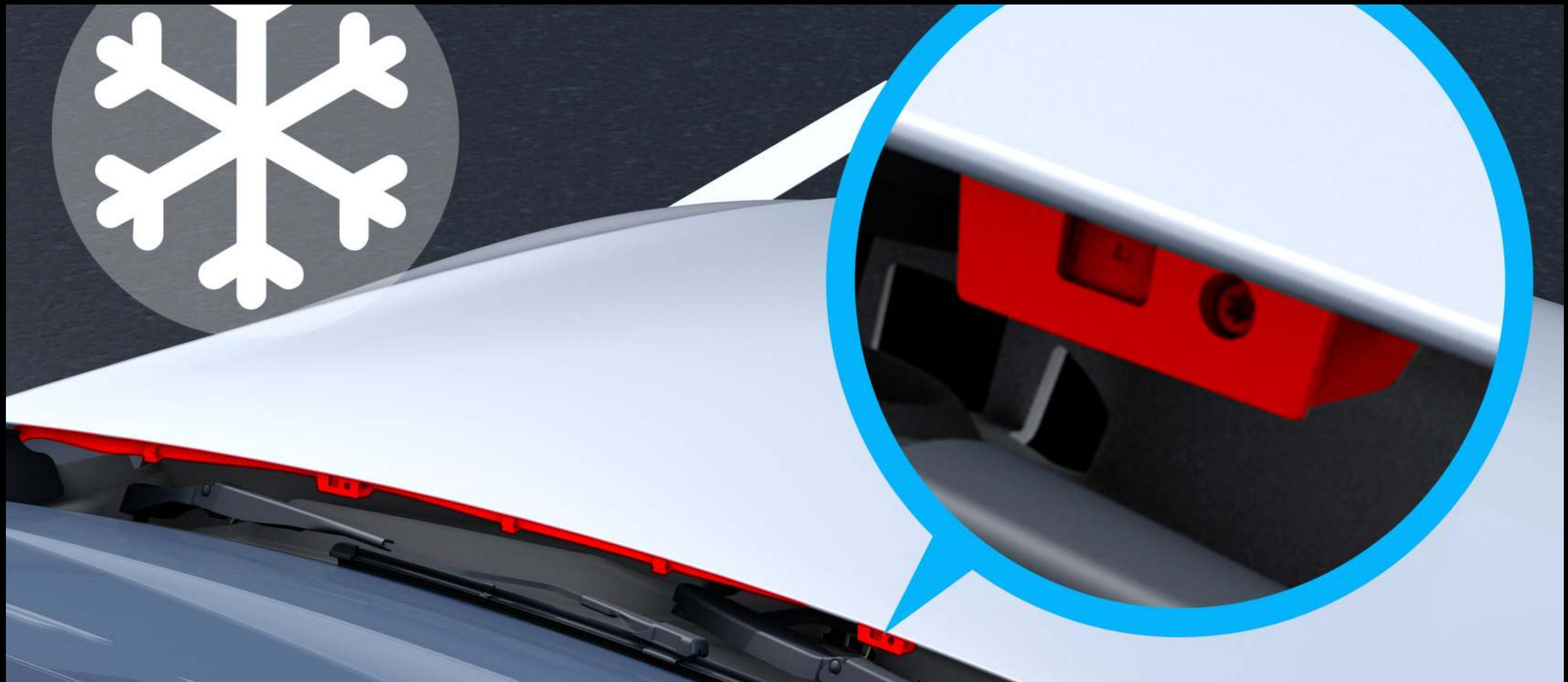
온열 윈드스크린 워셔 시스템은 추운 날씨에도 선명한 시야와 안전한 운전을 보장합니다. 특히  $5^{\circ}\text{C}$  이하의 온도에서 에너지 효율적인 모드로 작동하며 앞유리를 결빙 현상이 발생하지 않는 최상의 상태로 유지 시켜줍니다. (기본사양)
