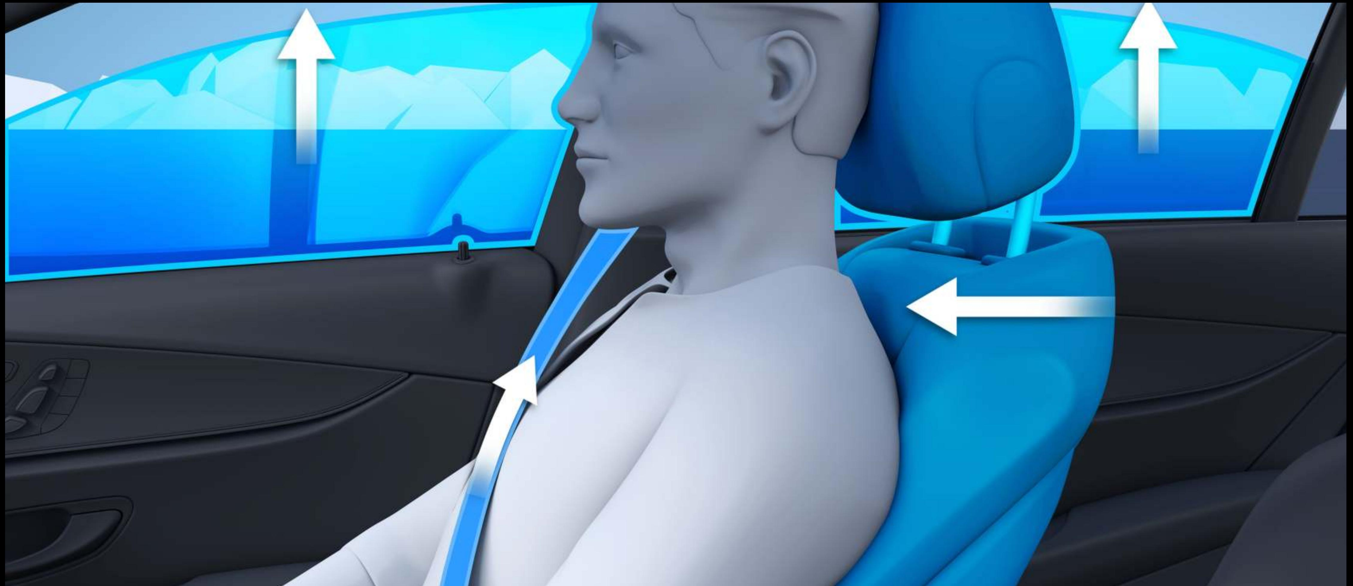
PRE-SAFE® 시스템이 사고로 인한 측면 충돌에 대비해 탑승자를 위험 구역에서 밀어내어 부상 피해를 줄여주고, 사고 시 발생하는 소음으로 인한 청각 스트레스를 완화합니다. 위험한 상황이 생기면 사운드 칩이 스피커를 통해 간접 신호를 방출하고, 청각을 보호합니다. 또한, 심각한 충돌 발생 시 안전벨트나 다른 에어백 시스템과 연계 작동하여 탑승자를 보호합니다. (기본사양)
