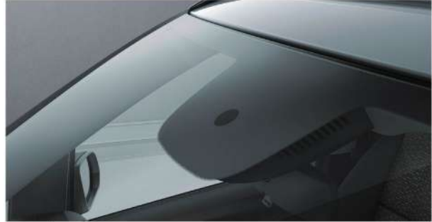
ใบปัดน้ำฝนทำงานและปรับความเร็วอัตโนมัติตามปริมาณน้ำฝน
