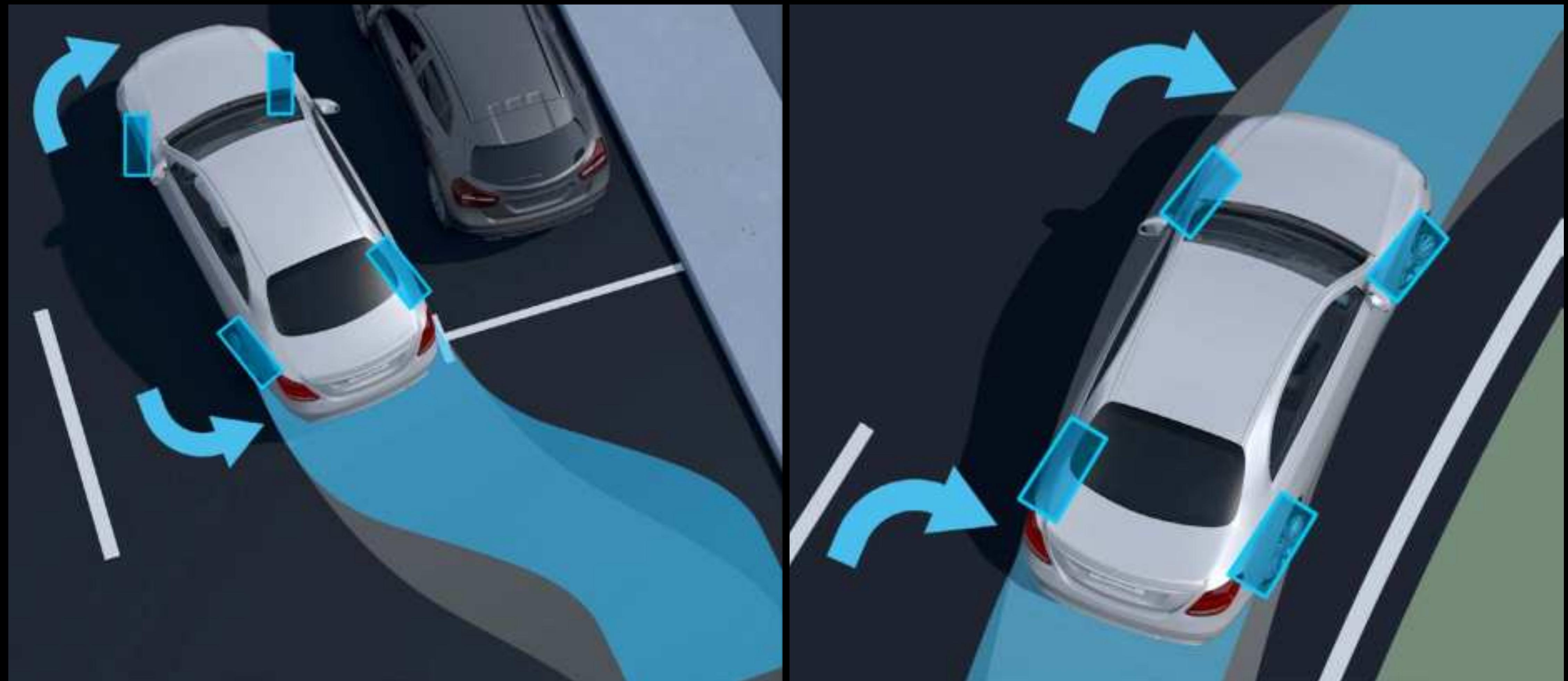
AMG 리어 액슬 스티어링은 커브길을 더 민첩하게 돌아 주행의 즐거움을 높여 줍니다. 차량 속도에 따라 휠베이스가 짧은 차량처럼 민첩하고 즉흥적인 스티어링 특성을 즐기거나, 고 속도로에서의 롱휠베이스 럭셔리 세단처럼 여유롭고 안정적인 주행도 가능합니다. 각 리어 휠에는 전기 액추에이터 모터가 있어 차량 속도에 따라 휠을 프런트 휠과 동일한 방향 또는 반대 방향으로 회전 시킬 수 있습니다. (기본사양)
