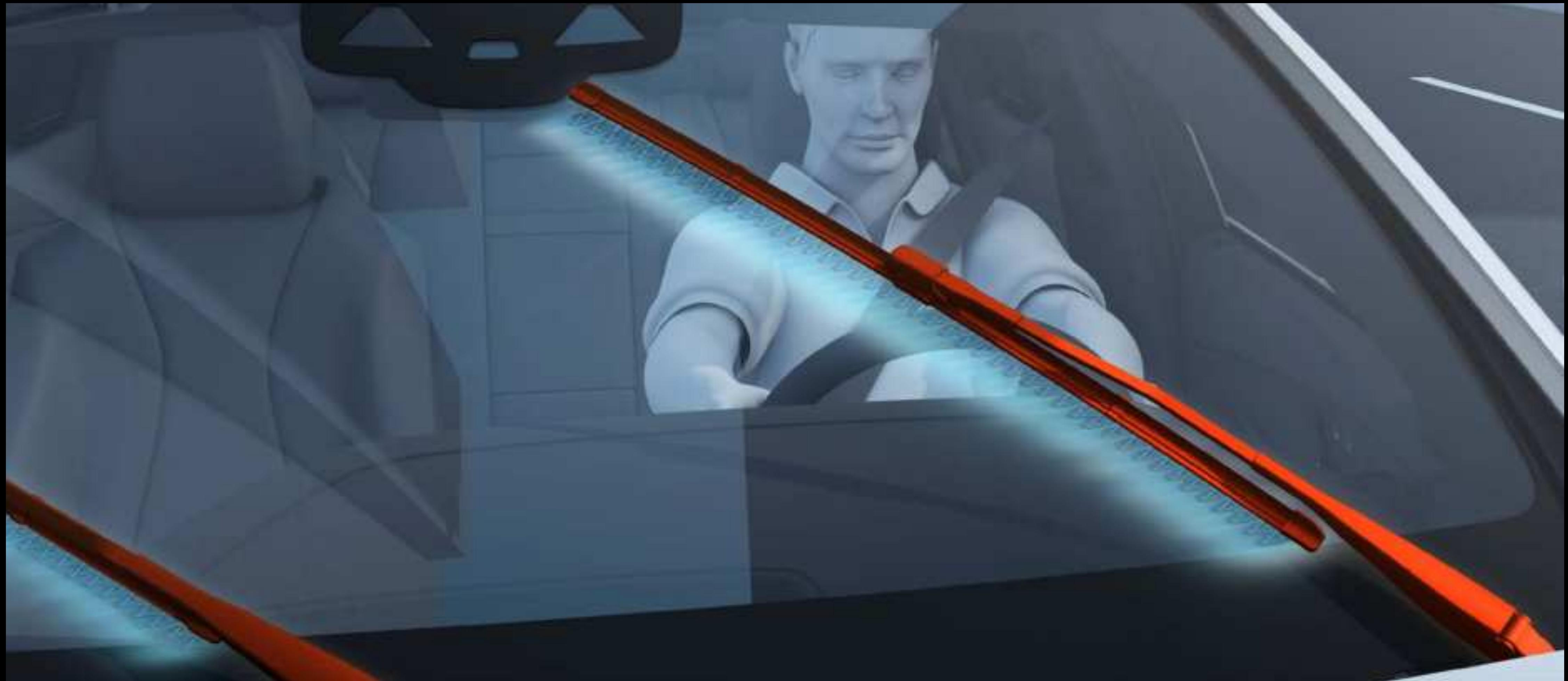
매직 비전 컨트롤은 차량의 주행 속도 또는 외부 온도 등의 다양한 주행 상황에 따라 와이퍼 날에서 직접 분사되는 물과 워셔액의 양을 조절하여 운전자가 시야를 확보할 수 있도록 지원합니다. 외부 온도가 영하일 경우 열선이 내장된 와이퍼 블레이드로 앞 유리에 눈이 쌓이는 것을 방지하여 와이퍼 작동 성능을 향상시키고, 레인 센서를 통해 오염 정도를 감지하여 세척이 필요한 곳에 워셔액을 집중적으로 분사하여 앞 유리를 더욱 효율적으로 닦아냅니다. 소프트탑을 개방한 상태로 주행할 경우, 분사되는 물의 양을 최소화하는 동시에 분사 방향을 아래로 조정하여 차량 내부로 물이 튀어 들어오는 것을 방지합니다. (기본사양)
