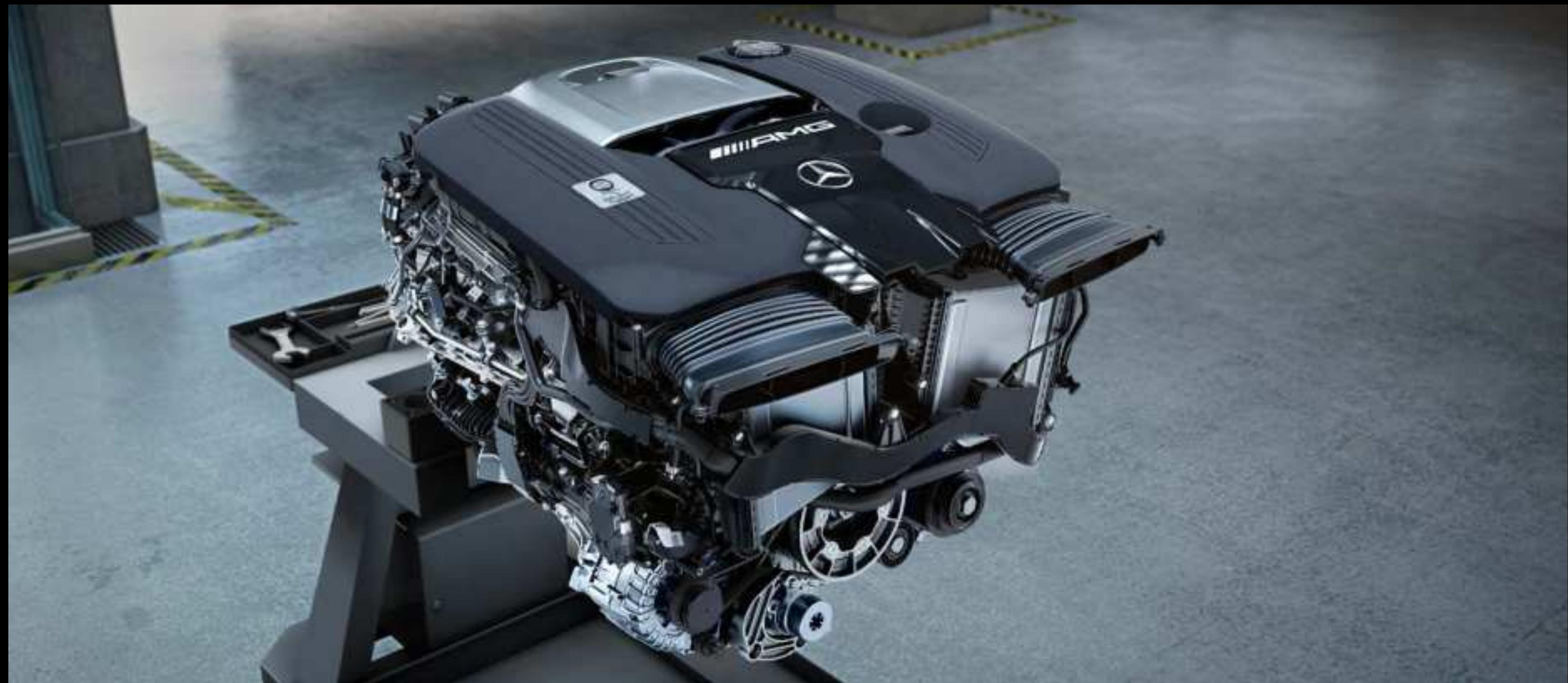
Mercedes-AMG SL의 4.0리터 V8 바이터보 엔진은 최대 출력 430kW, 최대 토크 800Nm로 정지 상태에서 시속 100km까지 가속하는 데에 3.6초가 소요되는 폭발적인 성능을 자랑합니다. 또한, 트윈 스크롤 터보차저를 실린더 헤드 사이에 위치함으로써 엔진 퍼포먼스가 개선되었으며, 실린더 라이너의 나노 슬라이드 코팅으로 마찰을 최소화하여 뛰어난 내구성을 보여줍니다.
