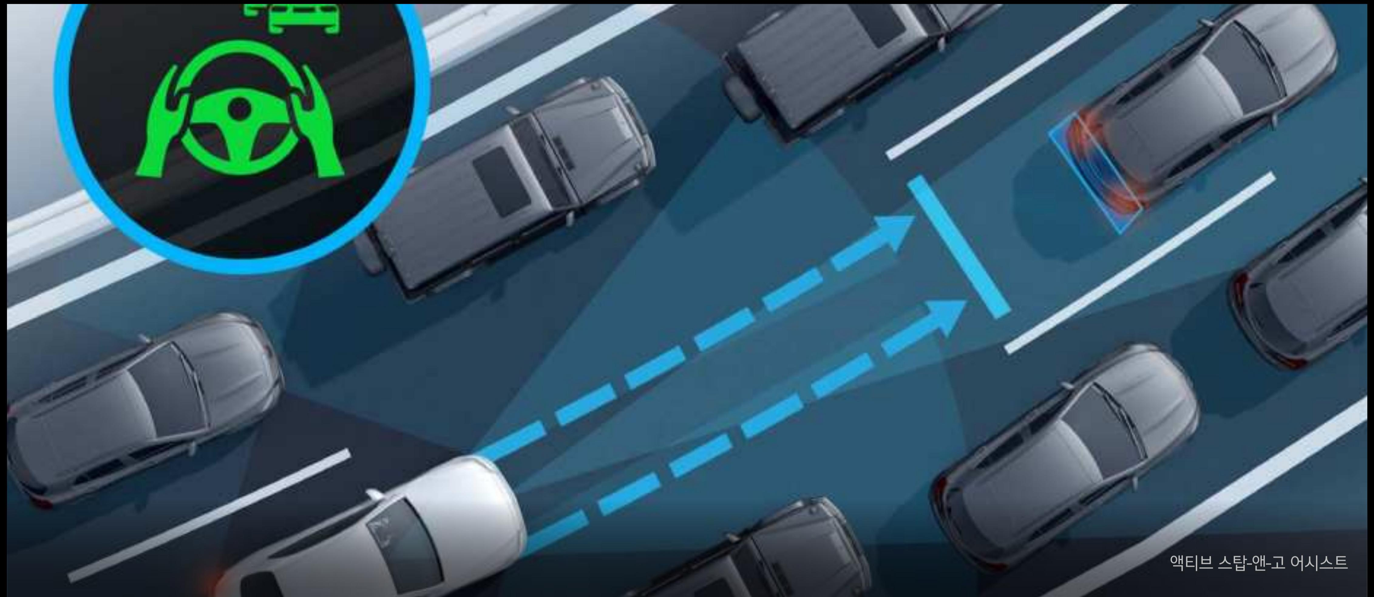
드라이빙 어시스턴스 패키지는 카메라, 레이더 및 초음파 등 주변을 기록하는 다양한 센서가 차량에 장착되어 실시간 정보로 경로 및 트래픽을 파악하며 각각의 정보는 지능적으로 서로 연계되어 있어 필요한 시점에 적절한 주행 보조 기능으로 발휘됩니다.
