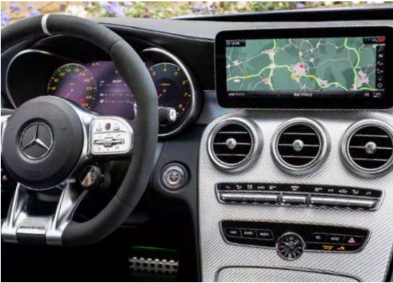
มาตรวัดความเร็วและรอบเครื่องยนต์แบบ All-Digital Instrument Display ขนาด 12.3 นิ้ว และ หน้าจอแบบ MB Audio 20 ขนาด 10.25 นิ้ว
