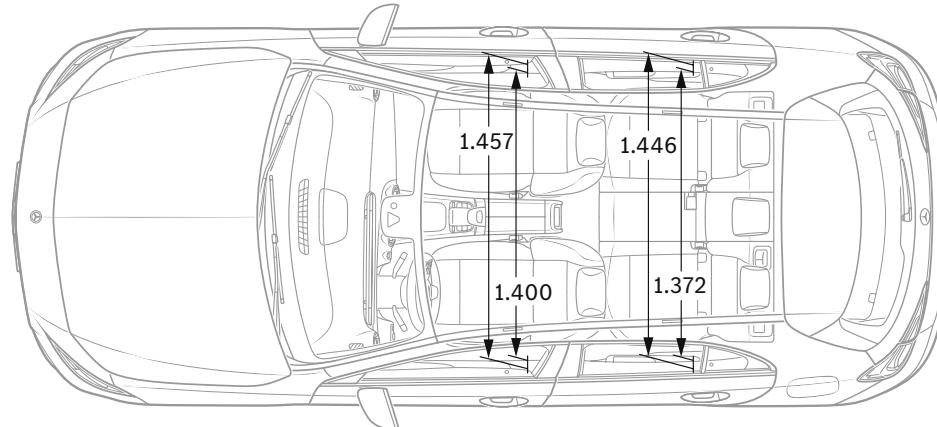
Alle Angaben in Millimetern. Die abgebildeten Maße sind Mittelwerte. Sie gelten für Fahrzeuge in Grundausstattung und in unbelastetem Zustand.
