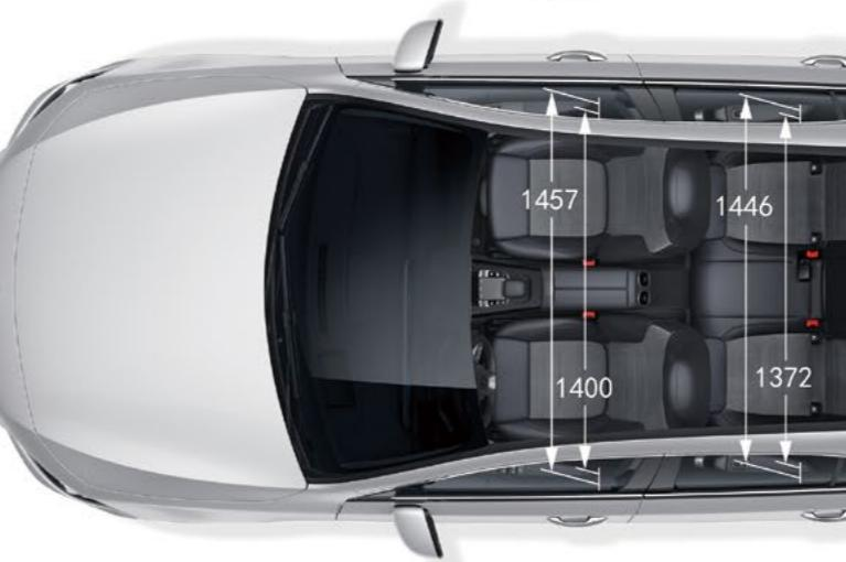
\*所有测量值均以“毫米”为单位。所示尺寸为平均值，适用于空载的标准车型。
