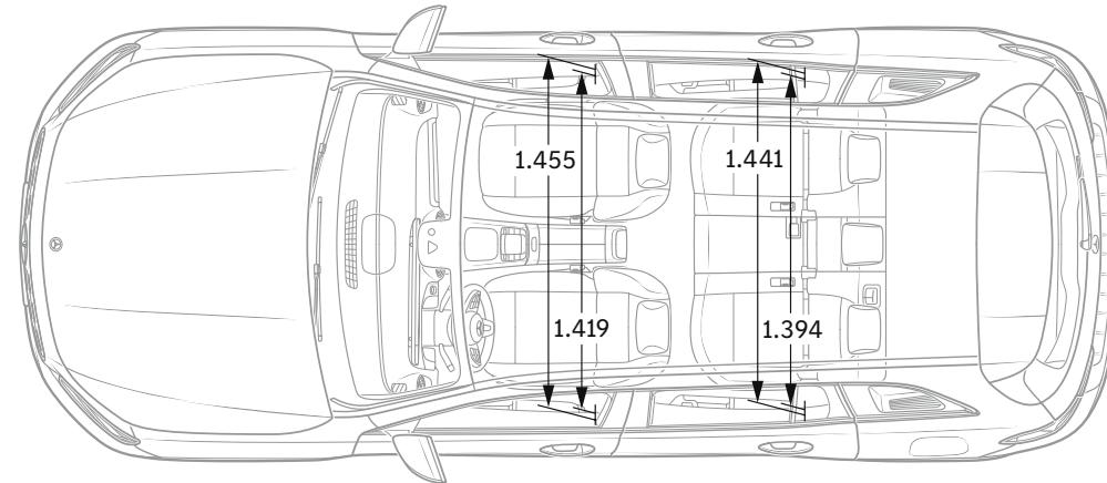
Alle Angaben in Millimetern. Die abgebildeten Maße sind Mittelwerte. Sie gelten für Fahrzeuge in Grundausrüstung und in unbelastetem Zustand.
