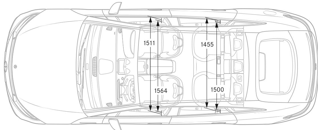
Все размеры указаны в миллиметрах. Указанные габариты являются средними значениями. Они действительны для автомобилей в серийной комплектации без загрузки.
