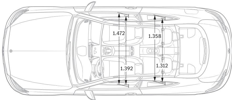
Alle Angaben in Millimetern. Die abgebildeten Masse sind Mittelwerte. Sie gelten für Fahrzeuge in Grundausrüstung und in unbelastetem Zustand.
