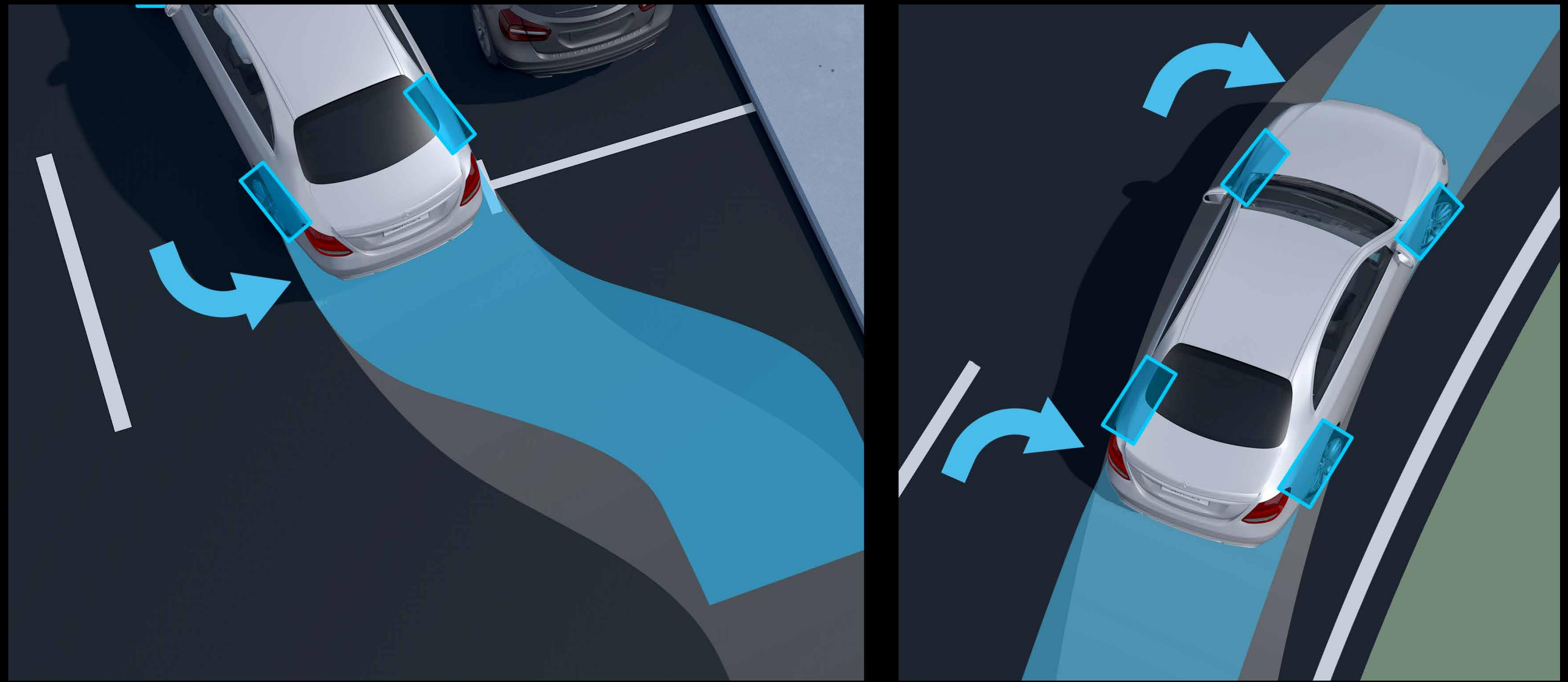
조향각이 2.5°인 리어 액슬 스티어링을 사용하면 주행 성능, 민첩성 및 주차 시 유연성이 향상됩니다. 60km/h 미만의 속도에서는 뒷바퀴가 앞바퀴와 반대 방향으로 조향되며, 이를 통해 차량의 기동성이 향상됩니다. 특히 회전하거나 빠른 방향 전환 또는 천천히 움직일 때 효과적으로 반응합니다. 또한, 60km/h를 초과할 경우 뒷바퀴는 앞바퀴와 동일한 방향으로 조향합니다. 이에 따라 고속 주행 시 안정적인 핸들링과 전반적인 안전성을 향상시켜 주어, 빠른 차선 변경 또는 회피 기동 시에도 안전하게 주행할 수 있습니다. (기본사양)
