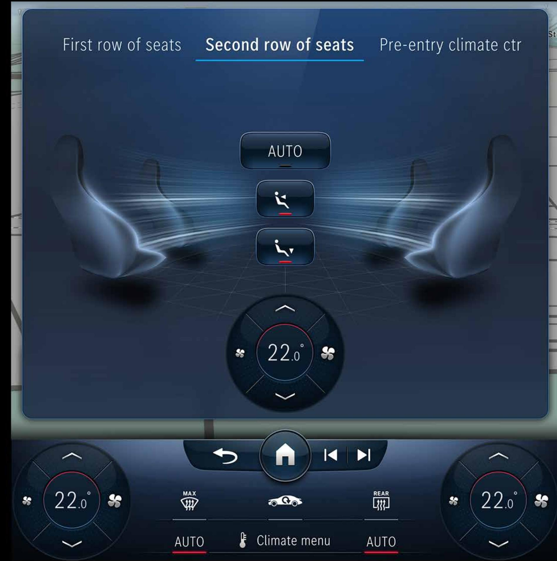
4개의 온도 조절 구역을 통해 운전자와 동승자 모두 개인적인 선호에 맞춰 온도와 공기를 개별적으로 관리할 수 있습니다. 섬세한 센서 시스템 덕분에 내부 온도를 일정한 수준으로 유지합니다. (기본사양)
