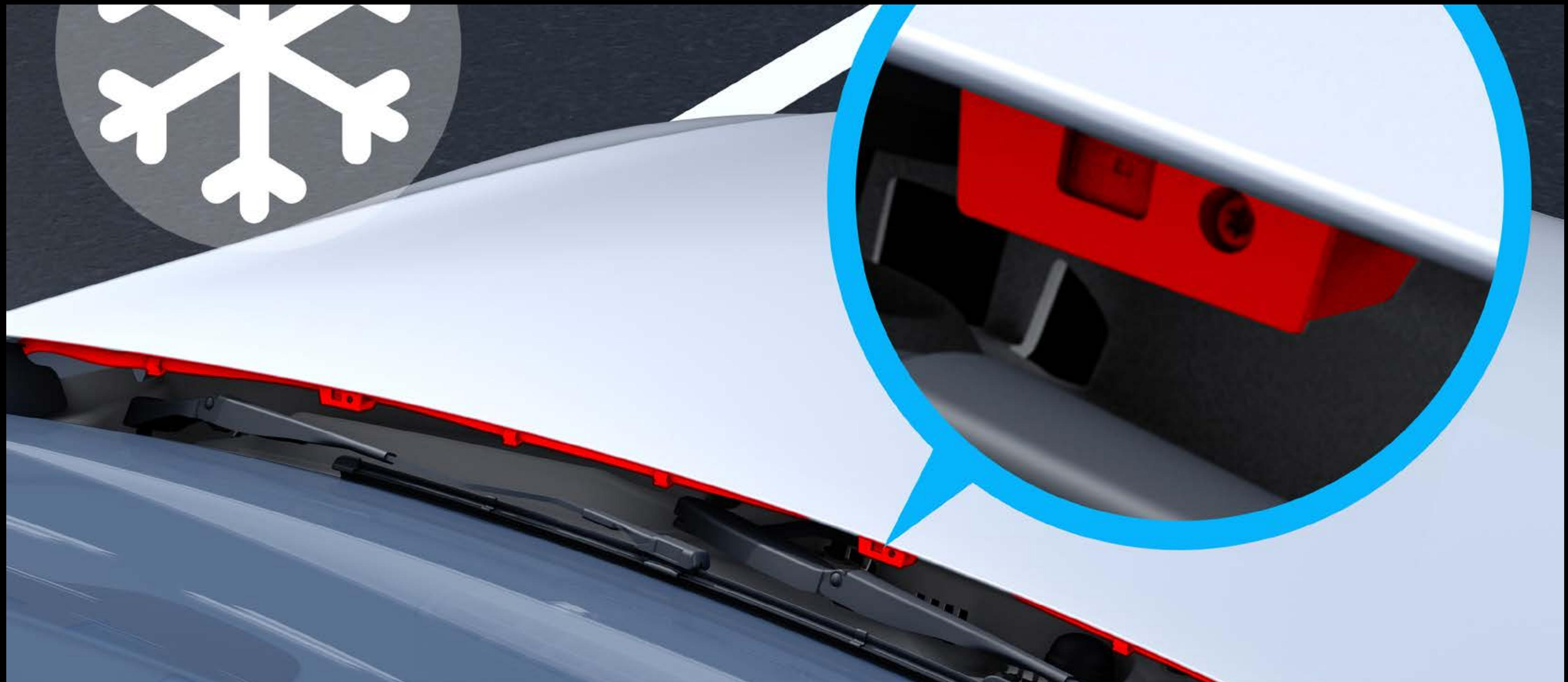
온열 윈드스크린 워셔 시스템은 추운 날씨에도 선명한 시야와 안전한 운전을 보장합니다. 특히 5°C 이하의 온도에서 에너지 효율적인 모드로 작동하여 앞유리를 결빙 현상이 발생하지 않는 최상의 상태로 유지 시켜줍니다. (기본사양)
