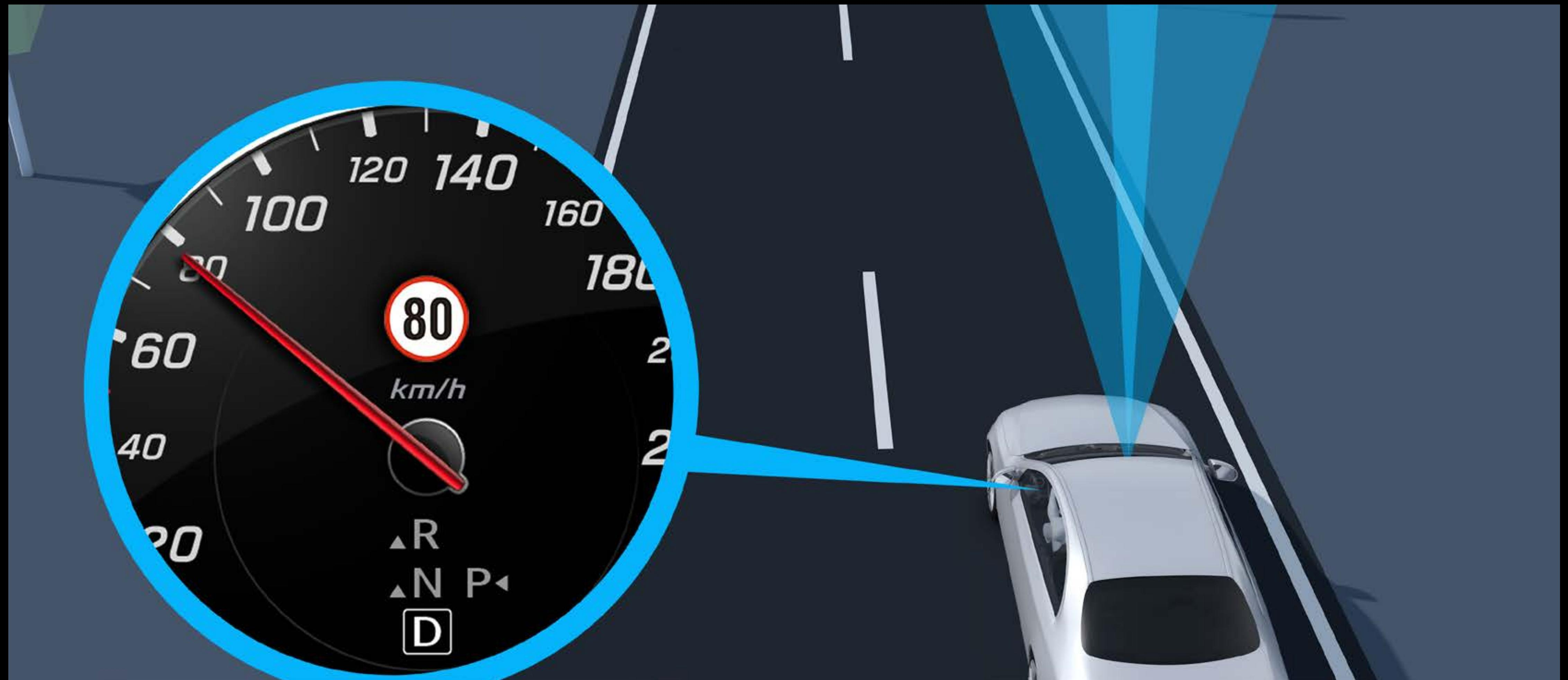
카메라와 내비게이션 데이터를 통해 준수해야 할 속도가 지속적으로 확인되므로 표지판이 많은 곳에서도 편리하게 제한 속도를 파악할 수 있습니다. 시스템을 통해 제한 속도를 알려주고 스티어링 휠의 버튼을 눌러 차량에 감지된 속도를 적용할 수 있습니다. 또한, 진입 금지, 일방통행, 고속도로 표지판을 식별하여 시청각적 경고를 제공합니다. (기본사양)
