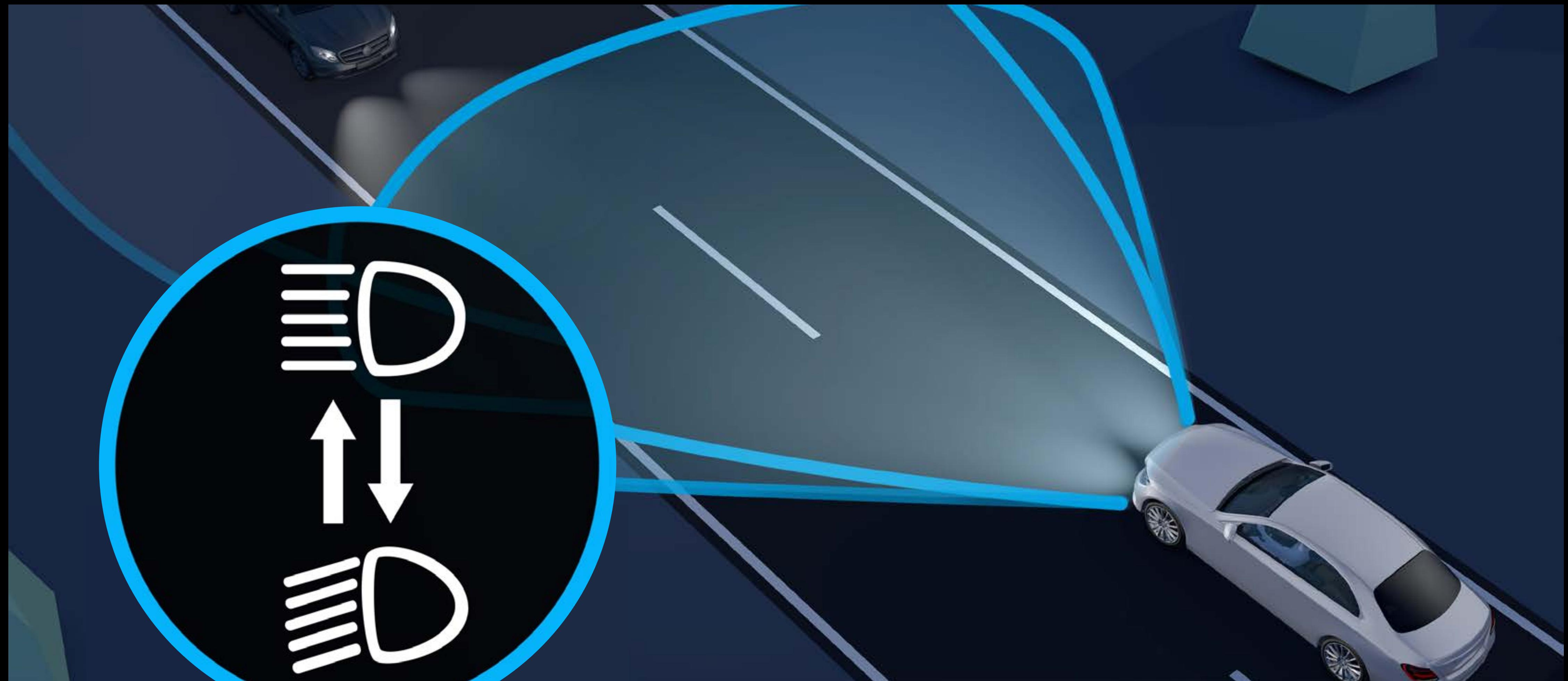
어댑티브 상향등 어시스트 기능은 전방에서 다가오는 차량이 감지되지 않을 경우 자동으로 상향등을 켜서 운전자의 시야 확보에 도움을 줍니다. 이 기능을 통해 노면의 상태와 도로 위 위험요소를 보다 명확하게 확인할 수 있습니다. (유료옵션)
