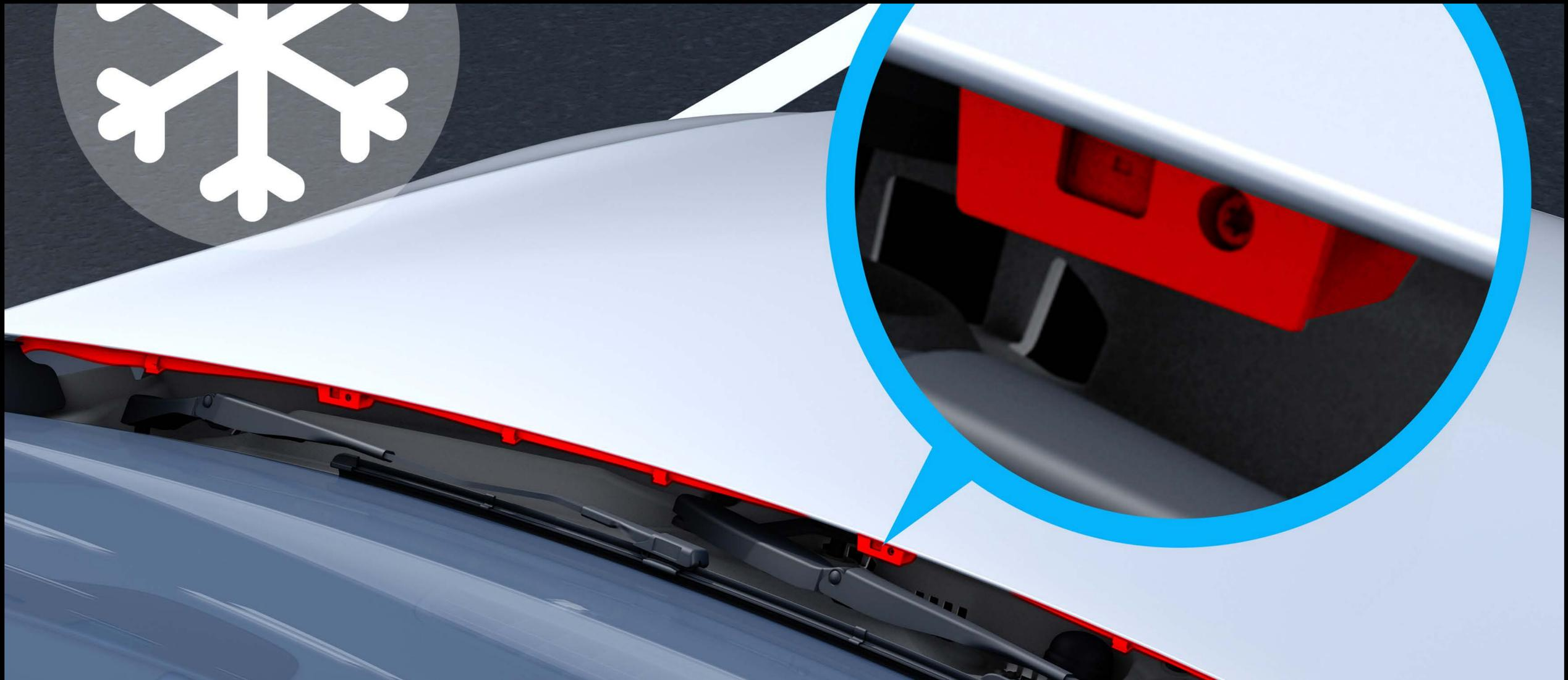
온열 윈드스크린 워셔 시스템은 추운 날씨에도 선명한 시야와 안전한 운전을 보장합니다. 특히 5°C 이하의 온도에서 에너지 효율적인 모드로 작동하며 앞유리를 결빙 현상이 발생하지 않는 최상의 상태로 유지 시켜줍니다. (기본사양)
