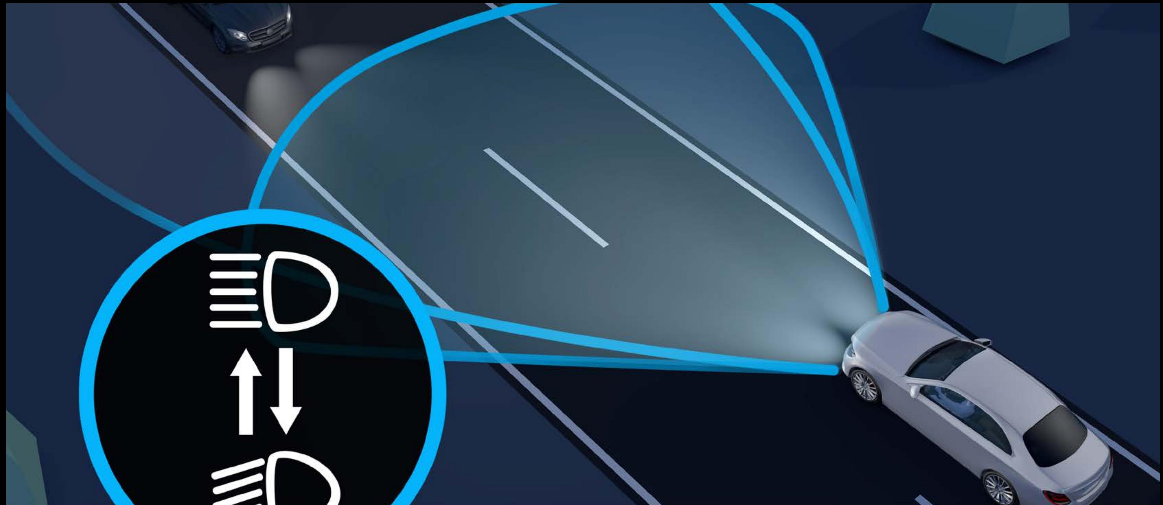
어댑티브 상향등 어시스트는 상향등이 활성화된 상태에서 전방에 있는 운전자들의 시야를 방해하지 않도록 지원합니다. 전방에 다가오는 차량이 감지되면 일부 헤드램프 모듈을 조정하여 선행 차량을 피해 운전자의 시야를 확보합니다. (기본사양)
