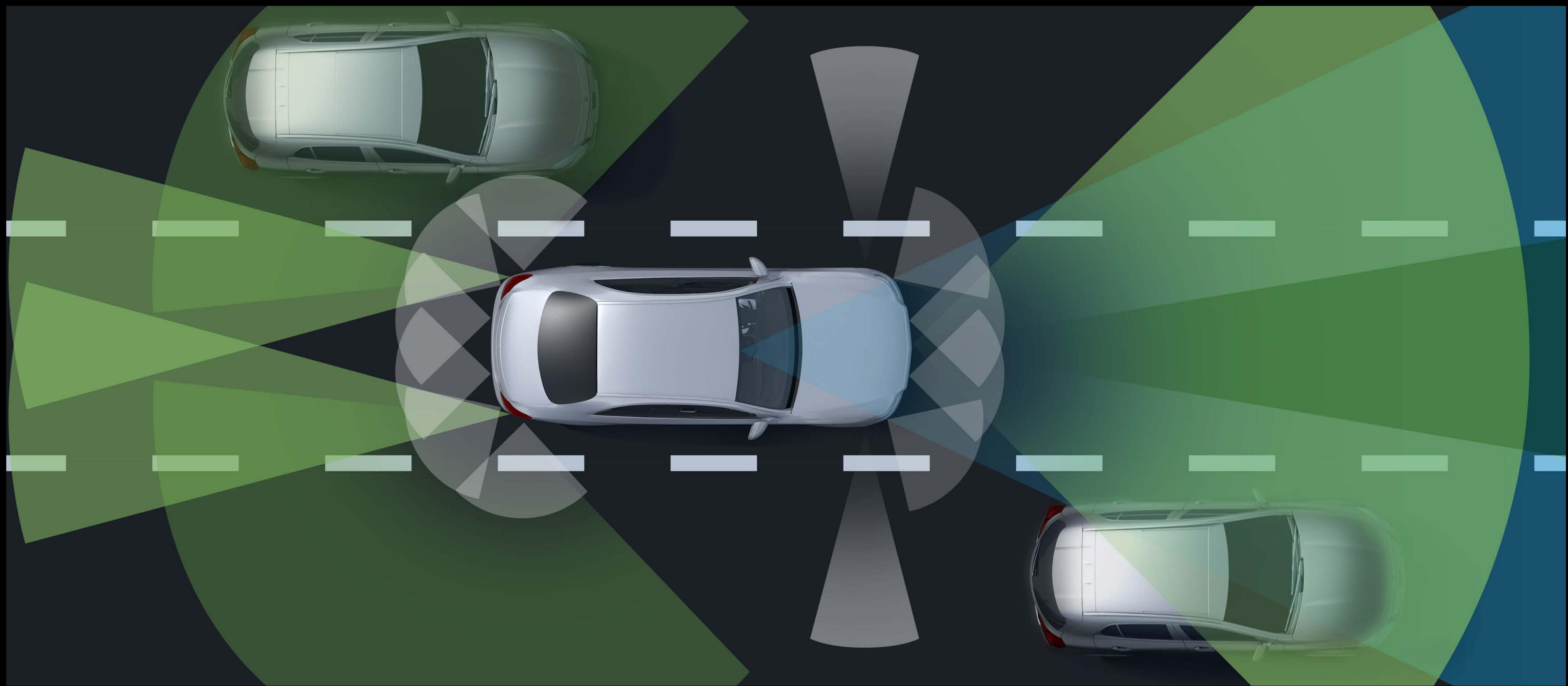
카메라, 레이더 및 초음파로 구성된 센서 시스템이 주변 환경을 분석하여 속도, 조향 제어 및 차간 거리 유지 등 필요 시점에 적합한 주행 보조 기능을 실행합니다. 코너, 원형 교차로, 나들목 또는 터널 게이트 등의 환경을 고려하면서 이동하는 트래픽에 따라 운전자를 대신하여 제동 및 가속을 제어합니다. 충돌 위험이 있는 경우 먼저 시청각적 경고로 운전자에게 알리고, 필요시 자동으로 제동 기능을 실행합니다. 또한, 고속도로 혹은 차선 표시가 있는 일반 도로에서 차선을 벗어나는 경우 차량 방향을 수정하기 위해 시스템이 조향에 개입해 탑승자와 보행자를 보호하여 사고 위험을 줄일 수 있도록 도움을 줍니다. (기본사양)
