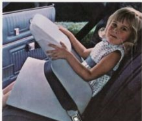
Siège de sécurité Tot-Guard protégeant les enfants mesurant de 19" à 25" de haut et pesant de 20 à 50 lb.
