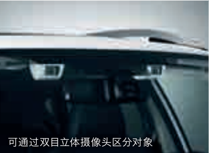
双目立体摄像头识别示意图(识别对象的高度约为1m以上)
