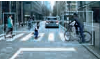
双目立体摄像头识别示意图 (识别对象的高度约为1m以上)
