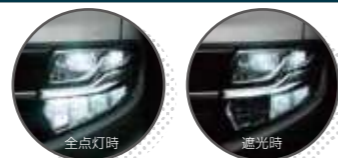
前方車両を検知してハイビームを部分的に遮光します。
