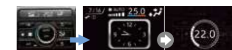
ダイヤルを操作するとディスプレイ上にポップアップ
