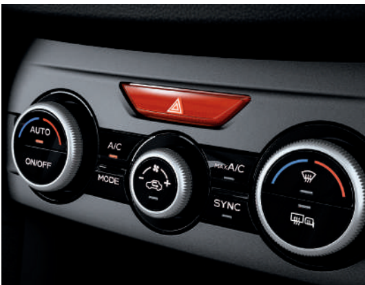
Contrôle de température automatique à deux zones 4
