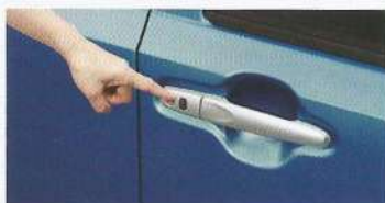
スイッチ操作でドアの施錠・解錠
