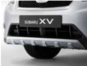
Protection inférieure de pare-chocs avant en résine
