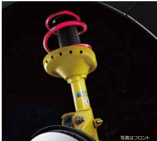
専用チューニング ビルシュタイン製ダンパー (フロント: DampMatic® II、倒立式) & コイルスプリング
