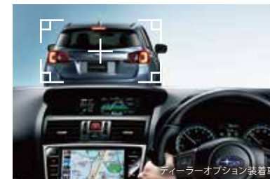
カラー画像化により、先行車のブレーキランプを認識
