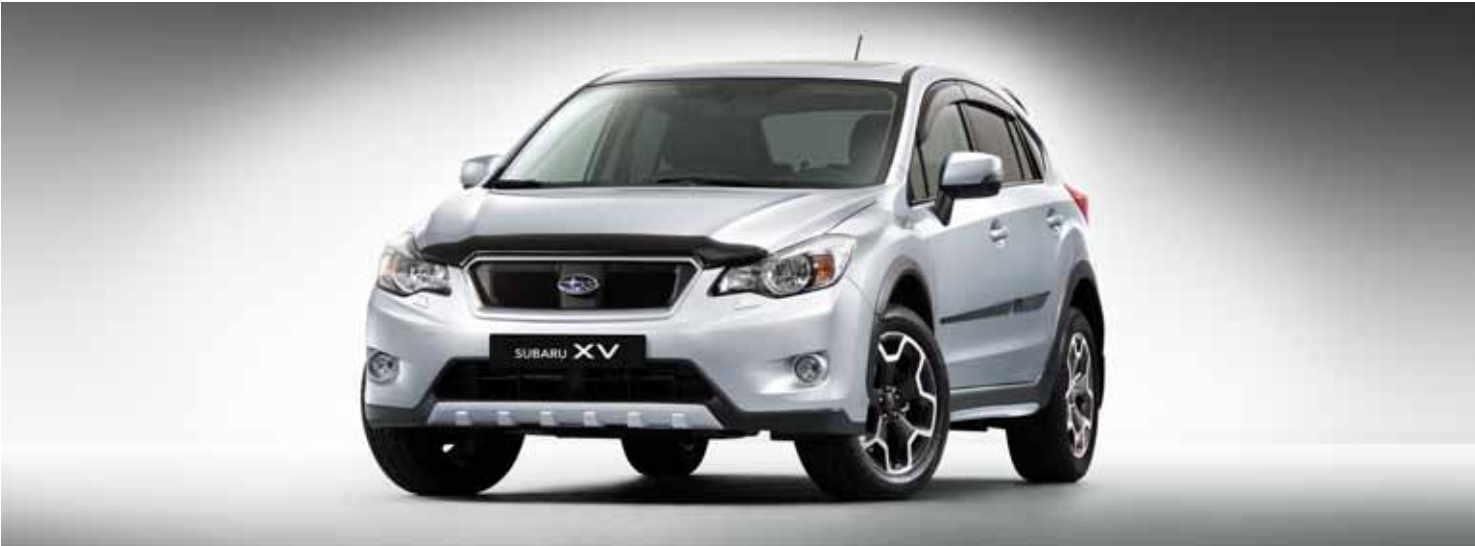
Véhicule présenté : déflecteur de capot, calandre avant (type grillagé), protection inférieure avant en résine, déflecteur de vitre latérale, protection inférieure latérale en résine, jeu de bavettes et spoiler de toit.
