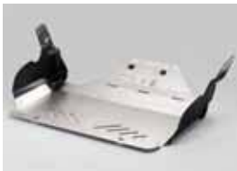
Dolna osłona silnika
