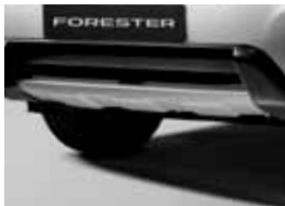
Osłona dolnej krawędzi przedniego zderzaka (laminat)
