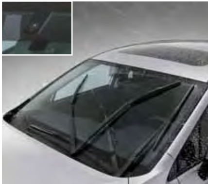
Wycieraczki z czujnikiem deszczu*1 Czujnik deszczu wykrywa obecność kropli wody na przedniej szybie i reguluje odpowiednio prędkość pracy wycieraczek oraz przerwy wyłącznika czasowego.
