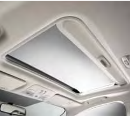
Elektrycznie otwierane szklane okno dachowe*1 Duże, elektrycznie otwierane okno dachowe, wyposażone w ręcznie odsuwaną osłonę przeciwsłoneczną, dostarcza wszystkim pasażerom panoramicznego widoku i, w razie potrzeby, świeżego powietrza.
