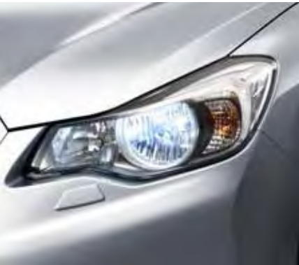
Przednie reflektory ksenonowe z układem samopoziomującym*1 Przednie reflektory ksenonowe oświetlają drogę światłem podobnym do dziennego. Układ samopoziomujący powoduje, że reflektory skierowane są zawsze pod właściwym kątem i optymalnie oświetlają drogę.
