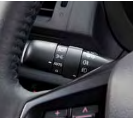
Reflektory, które automatycznie się załączają*1 Czujnik światła włącza reflektory automatycznie o zmroku, a wyłącza je po wyjęciu kluczyka ze stacyjki.
