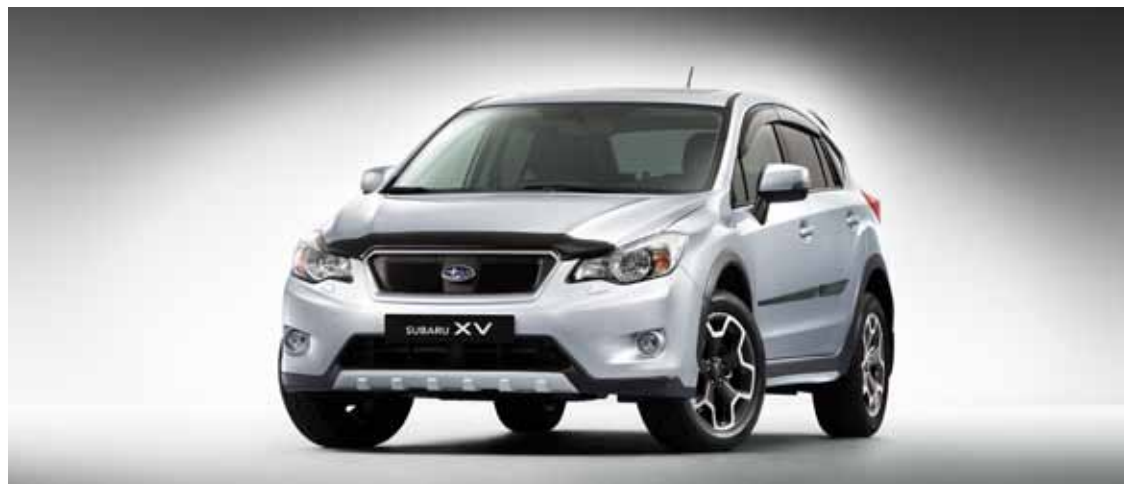
El modelo de la foto incluye Deflector de capó, Protector de resina inferior delantero, Parasol lateral trasero, Cortavientos, Protector de resina inferior lateral, Embellecedores laterales y Spoiler de techo
