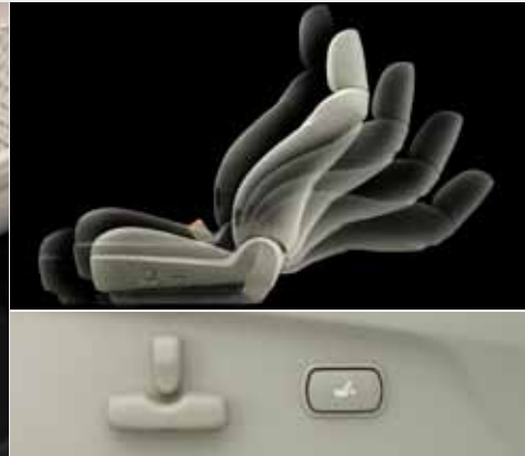
Elektrycznie regulowany fotel kierowcy*1 Elektrycznie regulowany fotel kierowcy ma możliwość regulacji w 10 płaszczyznach, co obejmuje także wsparcie lędźwiowe. Modele ze skórzaną tapicerką wyposażono w funkcję zapamiętywania ustawień, (również jako opcja przypisania ustawień fotela oddzielnie dla każdego egzemplarza klucza*1).
