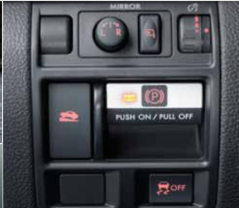
Elektryczny hamulec postojowy Obsługa hamulca postojowego przy użyciu przycisku jest łatwiejsza niż za pomocą mechanicznego pedału lub dźwigni. Ponadto takie rozwiązanie nie zajmuje miejsca w okolicy pedałów lub na centralnej konsoli.
