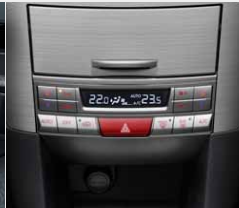
Dwustrefowa klimatyzacja Wszystkie wersje Outbacka wyposażone są w dwustrefową automatyczną klimatyzację z cyfrowym wyświetlaczem. Klimatyzacja ma funkcję odmrażania przedniej szyby po naciśnięciu jednego przycisku.
