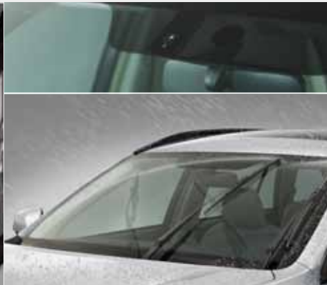
Czujnik deszczu Czujnik wycieraczek przedniej szyby wykrywa obecność kropel wody na szybie i reguluje odpowiednio ich prędkość pracy oraz przerwy wyłącznika czasowego.
