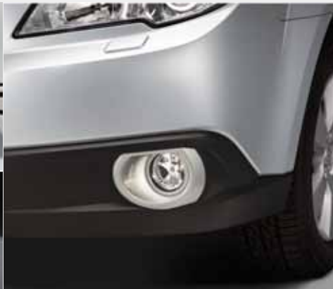
Przednie światła przeciwmglowe Światła przeciwmglowe z wielopłaszczyznowym odbłyśnikiem emitują szeroki i płaski strumień światła, który, przyczyniając się do bezpiecznej jazdy, minimalizuje zjawisko oślepienia we mgle.
