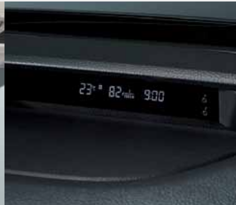
Wyświetlacz wielofunkcyjny Nad tablicą przyrządów znajduje się cyfrowy zegar, wyświetlacz pokazujący zewnętrzną temperaturę, bieżące i średnie zużycie paliwa, oraz dystans, jaki można przejechać na paliwie znajdującym się w baku.
