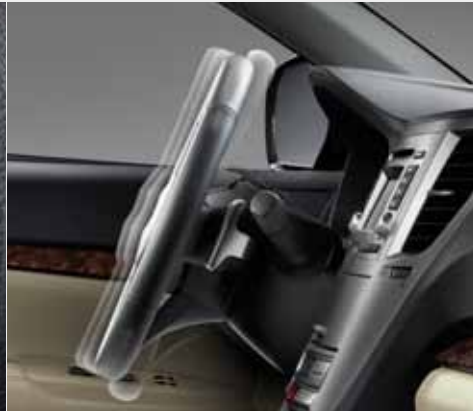
Kolumna kierownicza regulowana w dwóch płaszczyznach. Regulowana w dwóch płaszczyznach kolumna kierownicy, pomaga w ustaleniu jak najlepszej pozycji podczas prowadzenia samochodu.
