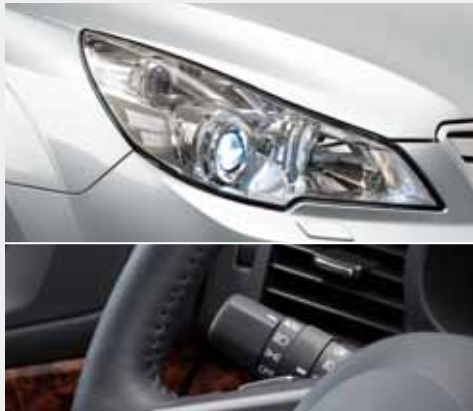
Automatycznie włączane i wyłączane reflektory przednie Czujnik światła automatycznie uruchamia reflektory o zmierzchu i wyłącza je po wyjęciu kluczyka ze stacyjki.
