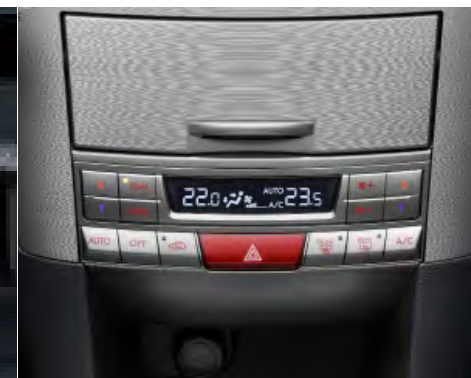
Dwustrefowa klimatyzacja Wszystkie wersje Outbacka wyposażone są w dwustrefową automatyczną klimatyzację z cyfrowym wyświetlaczem. Klimatyzacja ma funkcję odmrażania przedniej szyby po naciśnięciu jednego przycisku.
