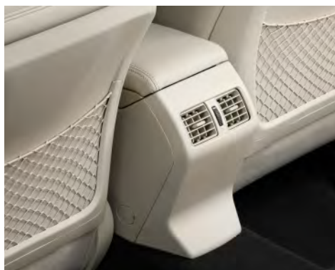
Wyloty powietrza w tylnej części kabiny* 1 Regulowane nawiewy tylnej części kabiny znajdują się na konsoli pomiędzy przednimi fotelami.
