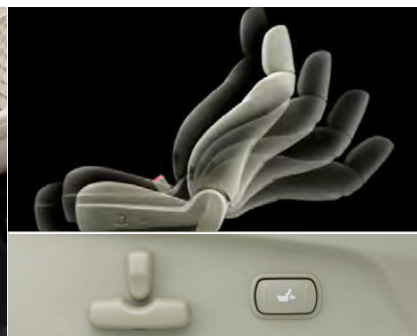
Elektrycznie regulowany fotel kierowcy* 2 Elektrycznie regulowany fotel kierowcy oferuje możliwość regulacji w 10 płaszczyznach, obejmujących także wsparcie lędźwiowe. Modele z tapicerką skórzaną są wyposażone w system zapamiętywania ustawień (również jako opcja przypisania ustawień fotela oddzielnie dla każdego egzemplarza klucza* 2 ).
