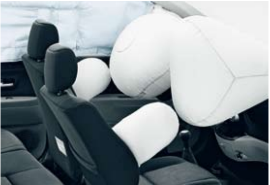
SRS* airbags en zijairbags voorin, plus gordijnairbags (1.0 Comfort S)
