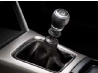
Handgeschakelde 6-versnellingsbak (6MT)
