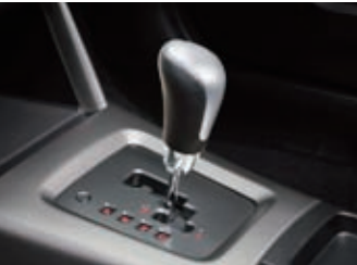
Transmission automatique à 4 rapports à contrôle électronique (SPORTSHIFT® E-4AT)
