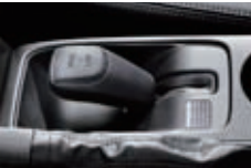
Levier de sélection Dual Range
