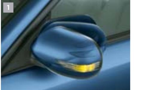
Rétroviseurs électriques rabattables avec clignotants à LED intégrés
